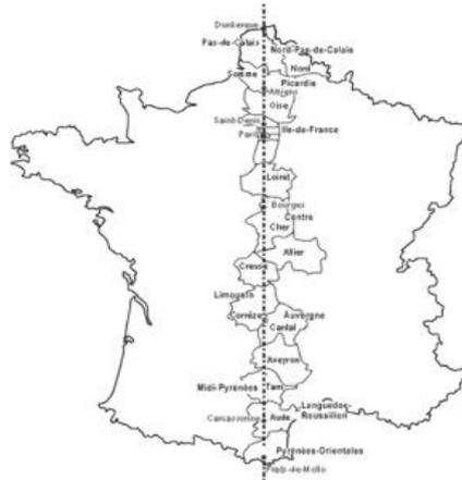
Mesure d'un arc de méridien depuis Dunkerque jusqu'à Barcelone. Delambre et Méchain, 1792 à 1798
